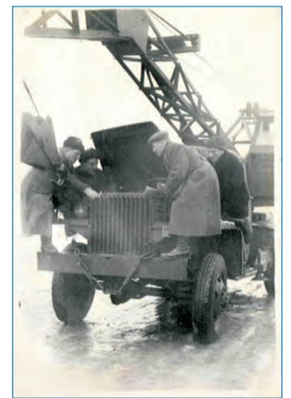
Техника, полученная по лендлизу. Автокран на базе Студобеккер. 40-е годы
