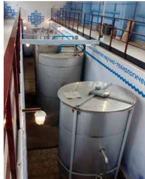
Пилотная установка процесса Анамокс в цехе механического обезвоживания НЛОС
