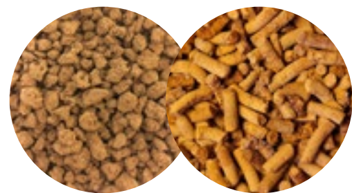
Каталитическая загрузка-сорбент импортного производства (слева) и собственного производства (справа).
