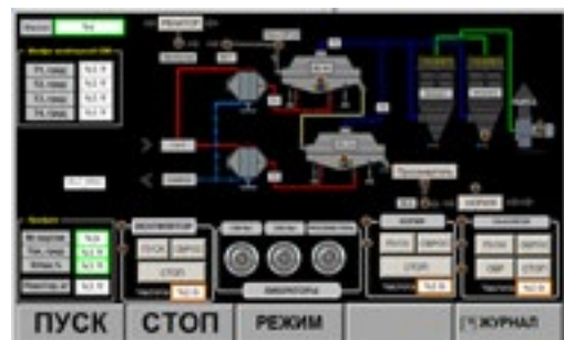
Схема технологической линии производства железосодержащего сорбента
